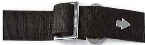
図21 3バーをロック完了です。 必ず図20でやったようにストラップの先を3バーに通してください。 ストラップの先は3バーに通したあと、 2～3インチ（約5cm～7.7cm）余るようにしてください。
